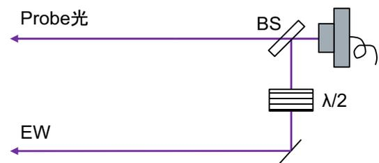
図 3.9 Probe 光のチャンバーへの出射系
