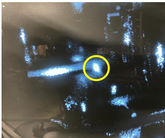
図 4.1 CCD カメラで撮影した原子雲
