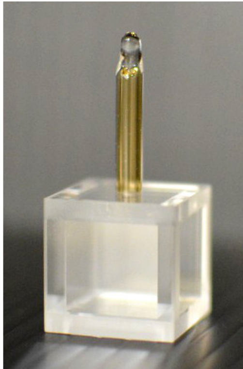
図 4.6 400°C バーク後のサファイアセル。枝管部が茶褐色に変色している。一方で、サファイア結晶部は透明なままである。
