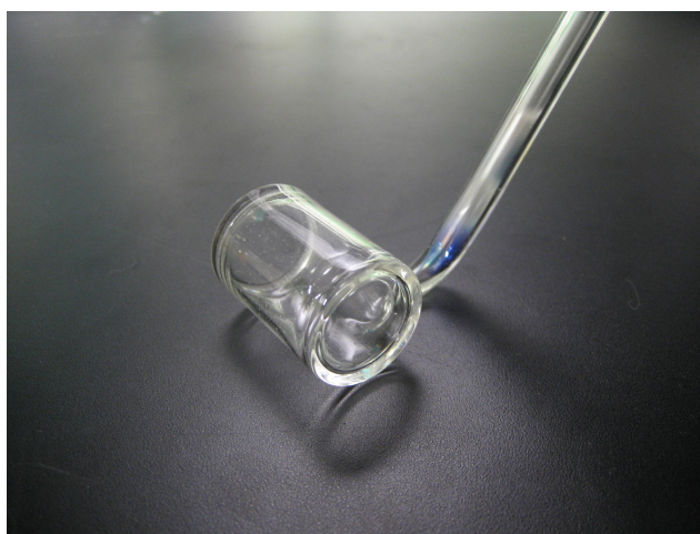
図 3.12 パラフィンコーティングセル#1 の写真. 円筒形のセルに細いガラス管 (枝管) が接続されている. 枝管はほぼ直角に曲がっていて, 曲がり角の付近にルビジウムが付着しているのが見える.
