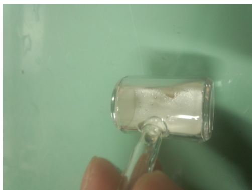
図 2.6 ベーク前の石英ガラスセル
