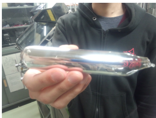
図 2.4 ベーク前の Rb 封入セル
