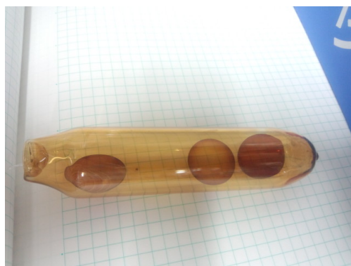
図 2.5 ベーク後の Rb 封入セル
