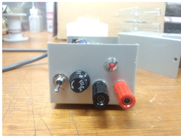
図 A.3 +5V 電源装置前面写真
