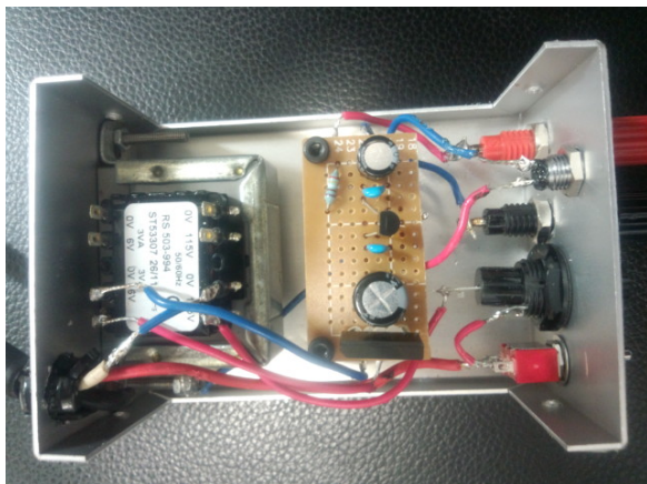
図 A.2 +5V 電源上からの写真
