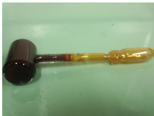
図 2.7 ベーク後の石英ガラスセル
