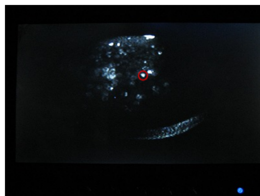
図 4.1.2 横 CCD カメラから撮影した MOT
