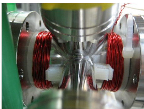
図 3.4.3 下部チェンバーに巻きつけたアンチヘルムホルツコイル
