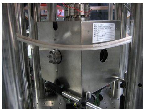
図 3.4.1 下部チェンバーを覆うパーマロイ磁気シールド
